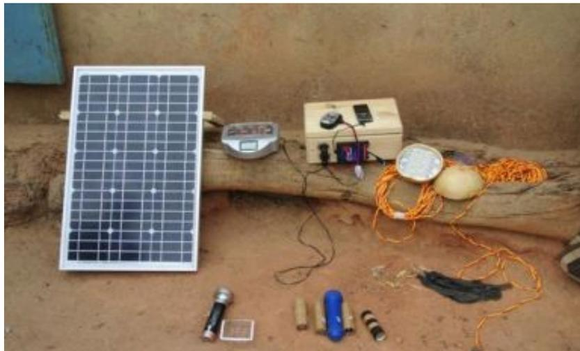
Ceci est un petit Solar-Home-System (SHS) de 20 Watt pour la lumière, pour recharger le téléphone portable et pour recharger des piles rechargeables pour les torches électriques. Il est très facile de construire un SHS soi-même. Tout le matériel nécessaire peut être acheté sur le marché burkinabé, il suffit donc de savoir quelles pièces acheter et comment les assembler. Cette petite notice vous accompagnera pendant le montage.
